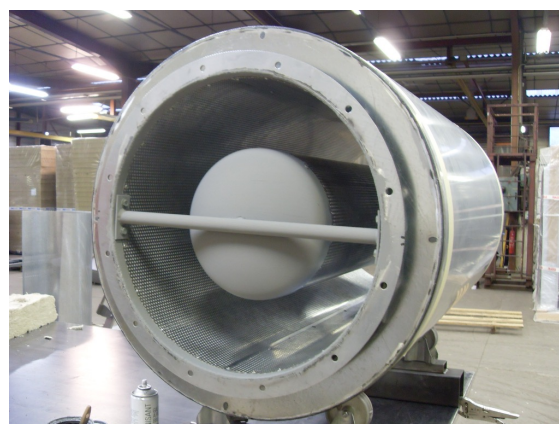
- Silencieux acoustique sur cheminée -
